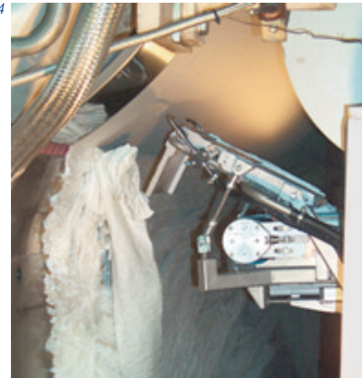
Abb. 4: Abnahme-Einrichtung, eingebaut bei Lang Papier, Deutschland.
