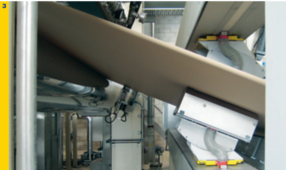
Kuva 3: Sirius-rullaimella edestakaisin liikkuvassa skannerissa on sensorit mittaamassa pintapainoa, kosteuspitoisuutta ja värisävyjä.
