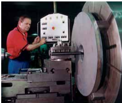
Abb. 4: Bearbeiten eines Walzen-Gummi-Bezuges.
