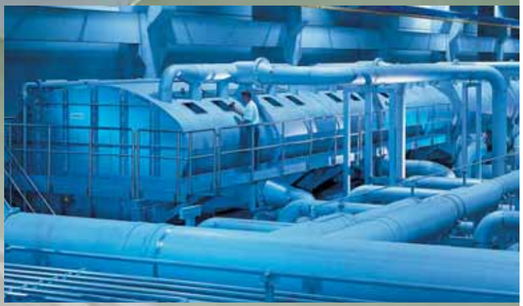
Abb. 2 und 3: Dispergier- und Deinkinganlage der neuen Stoffaufbereitung.
