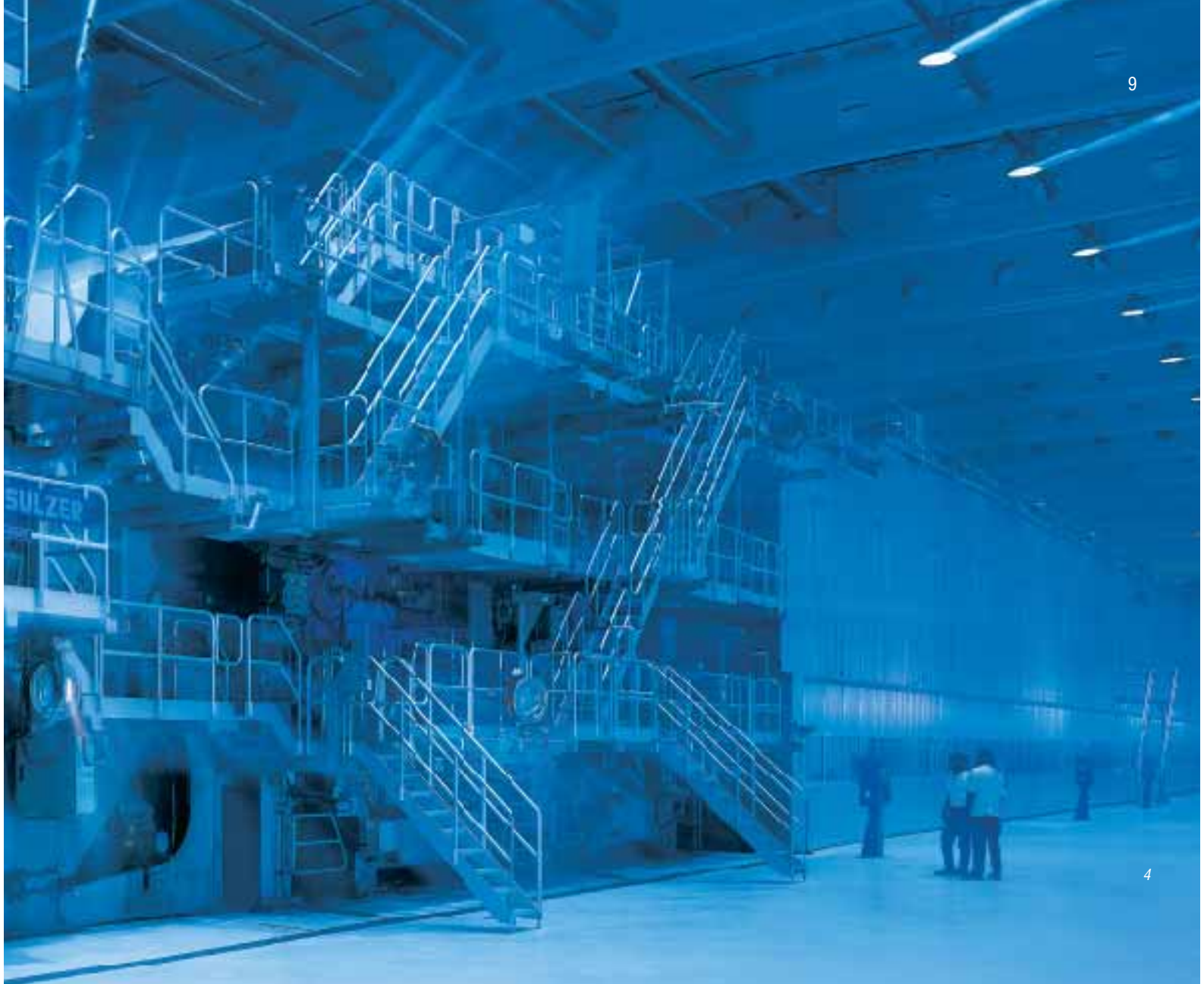
Abb. 4 bis 7: Die PM 3 Eltmann, ausgelegt für 250.000 Jahrestonnen Zeitungsdruckpapier zwischen 34 und 60 g/m 2 . – Eine Mannschaft sehr zufrieden mit der Technik und den ersten Qualitätsergebnissen.
