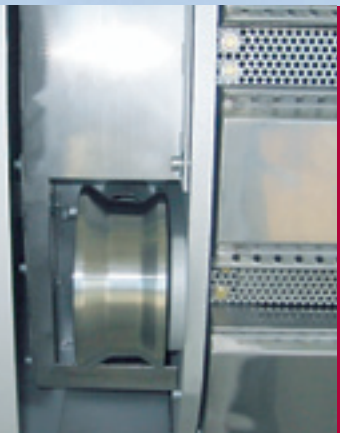
Abb. 6: Zusätzliche stirnseitige Luftrückführung.
