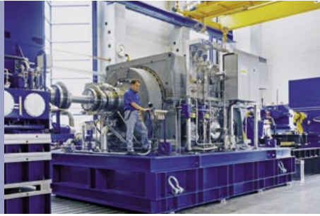
Крупнейший на сегодняшний день редуктор Vorecon (33 МВт) на испытательном стенде в Крайлсхайме.
