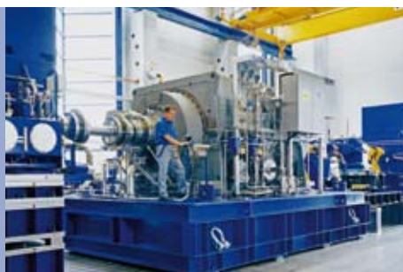
Der bisher größte Vorecon (33 MW) auf dem Prüfstand in Crailsheim.
