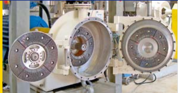
TwinFlo-jauhinten energiaa säästävät Pluralis-jauhinlevyt.
