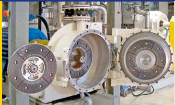
Die Technologiezentren bilden ein weltweit gut funktionierendes Netzwerk. TwinFlo-Refiner mit energiesparender Pluralis-Garnitur.
