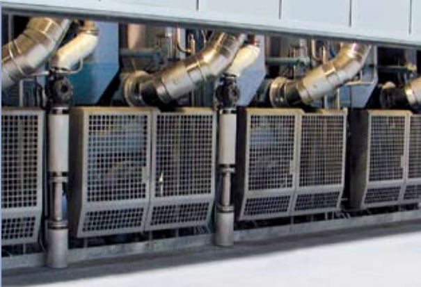
Pilotinstallation SafeTailing – Trockenpartie mit Zugangssicherung.
