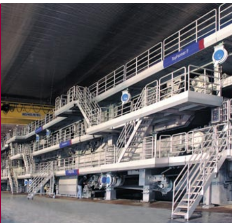
Рис. 1: На многослойных КДМ можно выполнять измерения на разных напорных ящиках.
