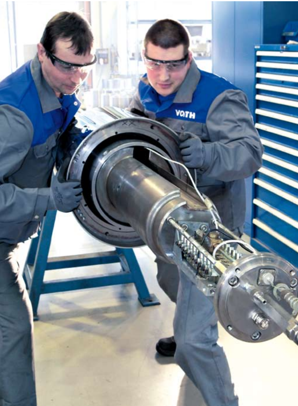
Demontage der einzelnen Segmente einer Breitstreckwalze.
