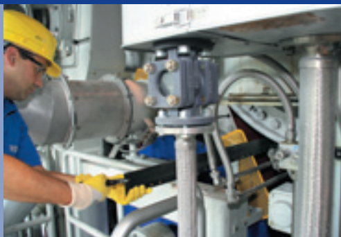
Voith Paper Rolls Service Mitarbeiter beim Schaberwechsel
