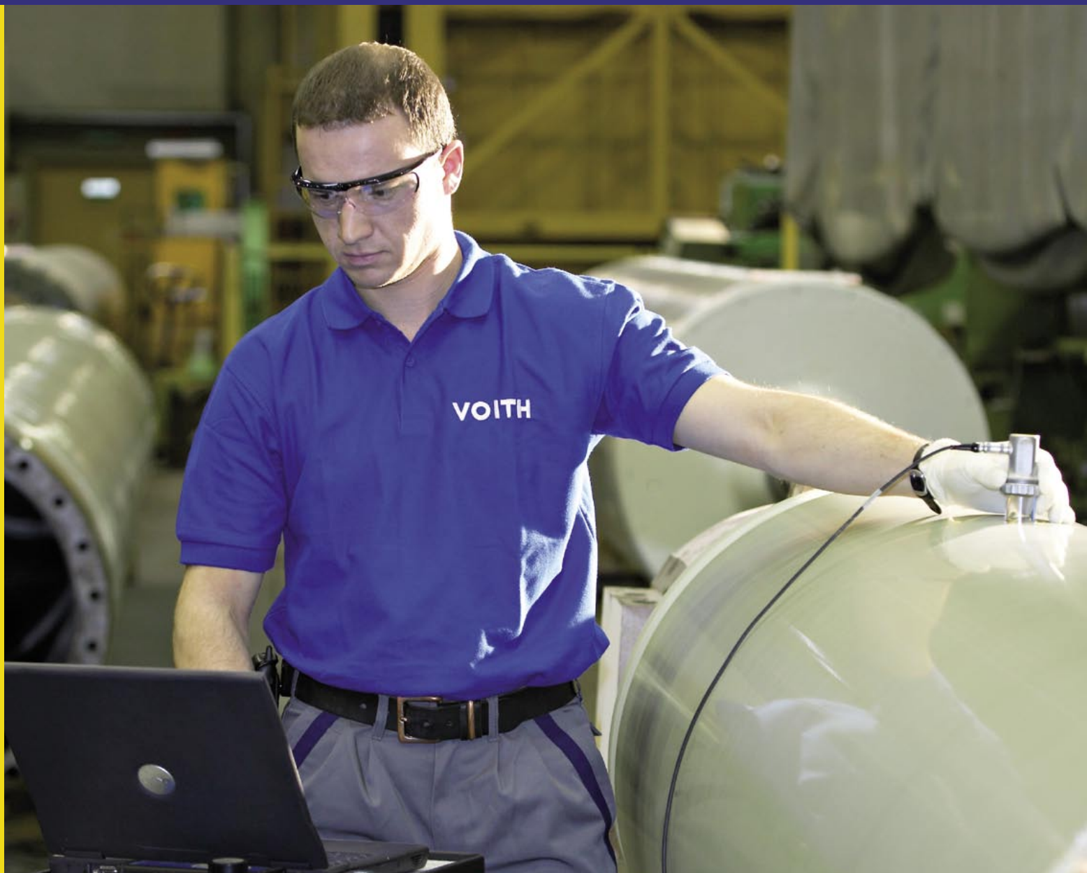
RollCare: Ультразвуковая дефектоскопия покрытия вала.
