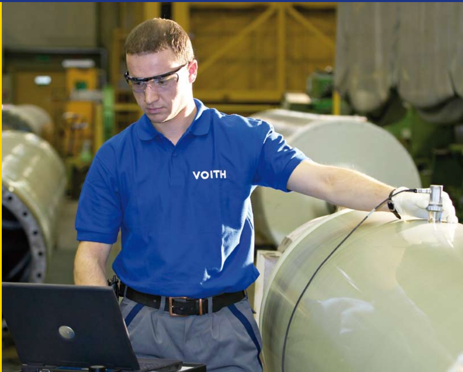
RollCare: Ultraschall Untersuchung des Walzenbezuges.
