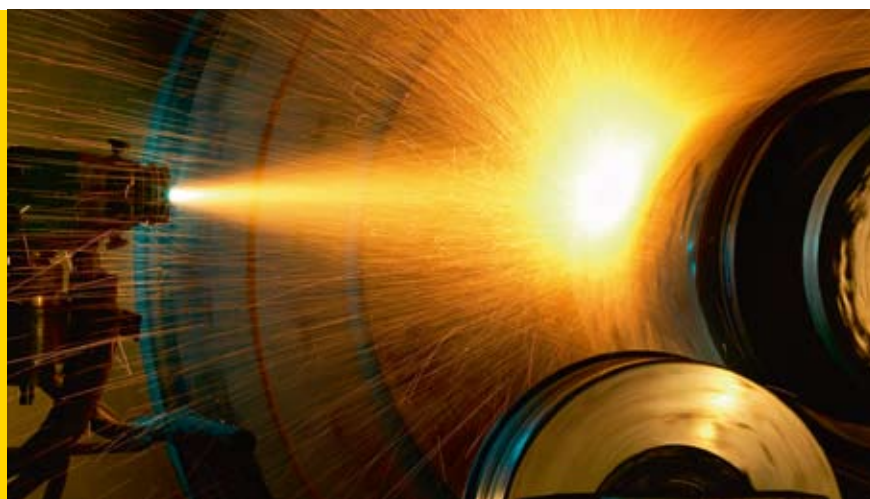
RollRep: Thermische Beschichtung von Zapfen.
