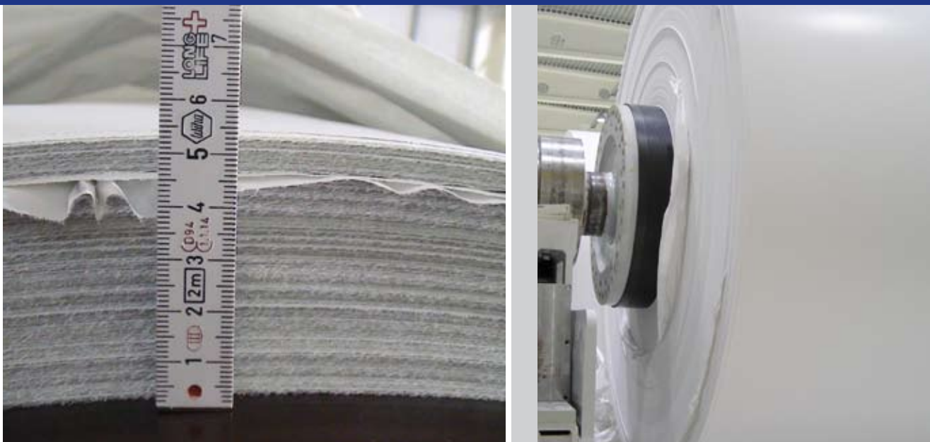
Abb. 2: Beispiele für Wickelfehler.
