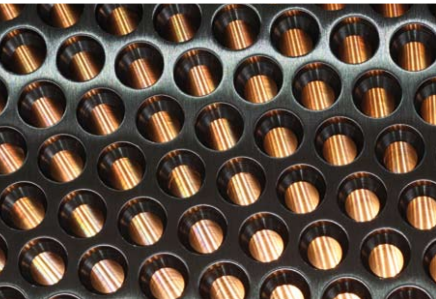
Mittatarkkuutta kerrakseen: Imutelan reiät tehdään kanuunaporassa olevilla poranterillä.
