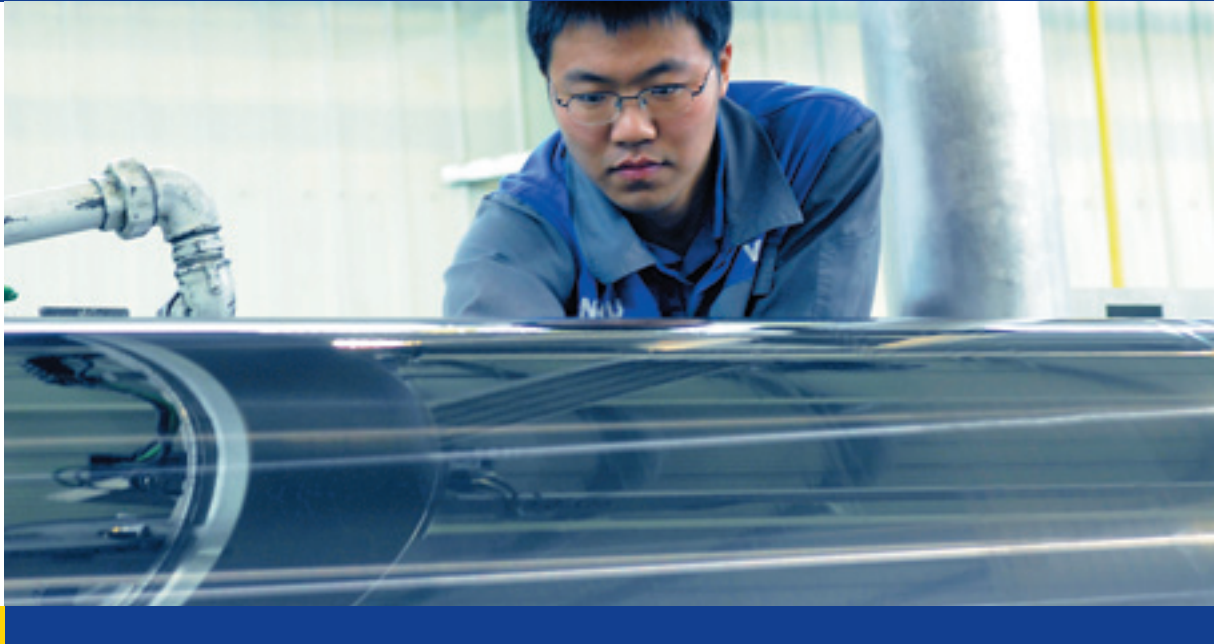
Schleifen einer CeraCal Plus Walzenbeschichtung
