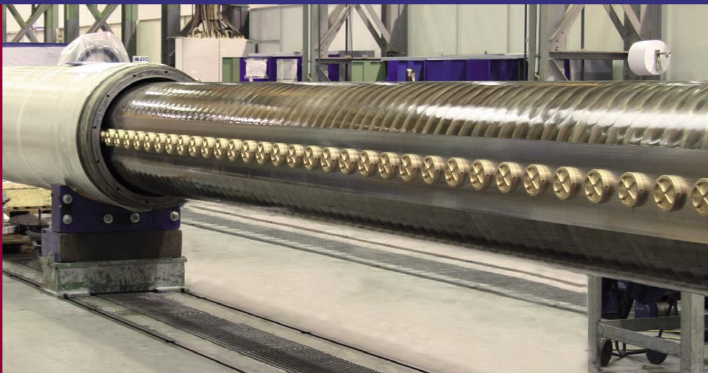
Реконструкция того же вала NipcoScoop по технологии опорных контрэlementов.
