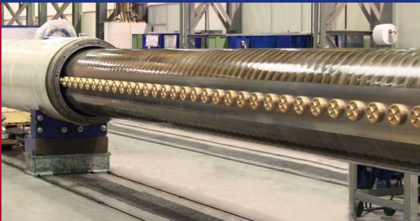
Die gleiche Nipcorect-Walze beim Umbau auf durchgehende Gegenstützquellen.
