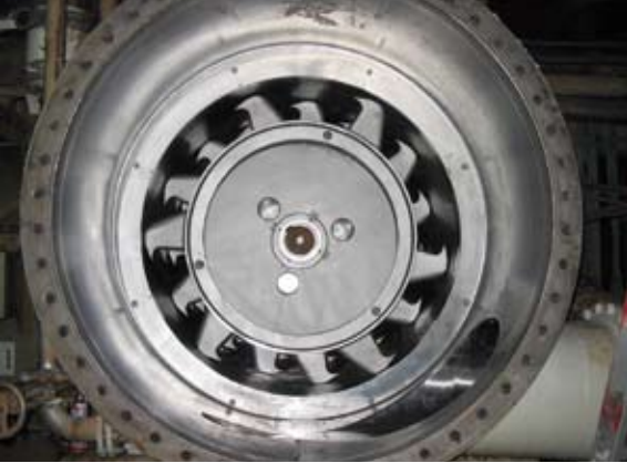
TLA 450 -lajittimen muunnos MultiFoil-roottorin ja C-bar-sihtikorin yhdistelmällä.
