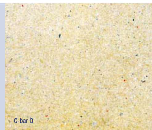
C-bar Q Qualitätsvorteile auf einen Blick: offensichtlich weniger Störstoffe im Gutstoff. Musterblätter von Proben aus der zweiten Stufe OCC Langfaser-Feinsortierung.
