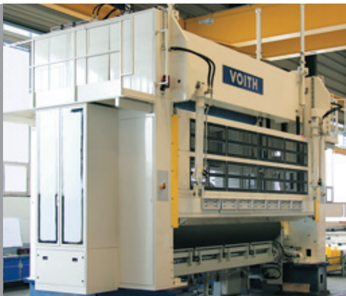
VariFlex-leikkuri tehtaalla asennettuna
