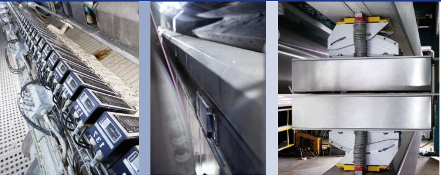
Durchgängiges Qualitätsleitsystem vom Stoffauflauf bis zur Aufrollung: OnQ ModuleJet, OnQ EnviroScan und OnQ Scanner.
