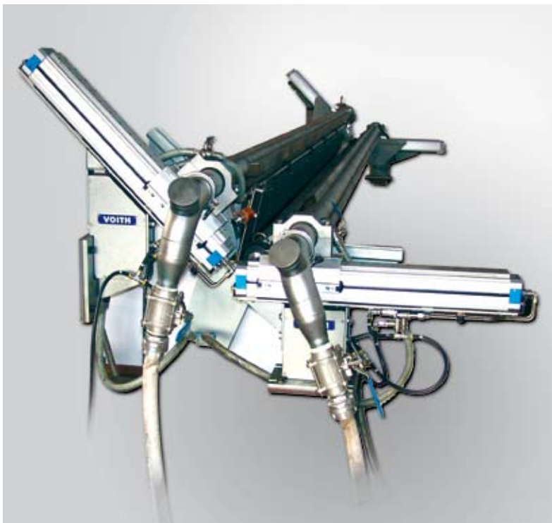
SizeWings AT mit Bewegungseinrichtung für eine flexible Fahrweise (ein- oder doppelseitig) der Leimpresse.
