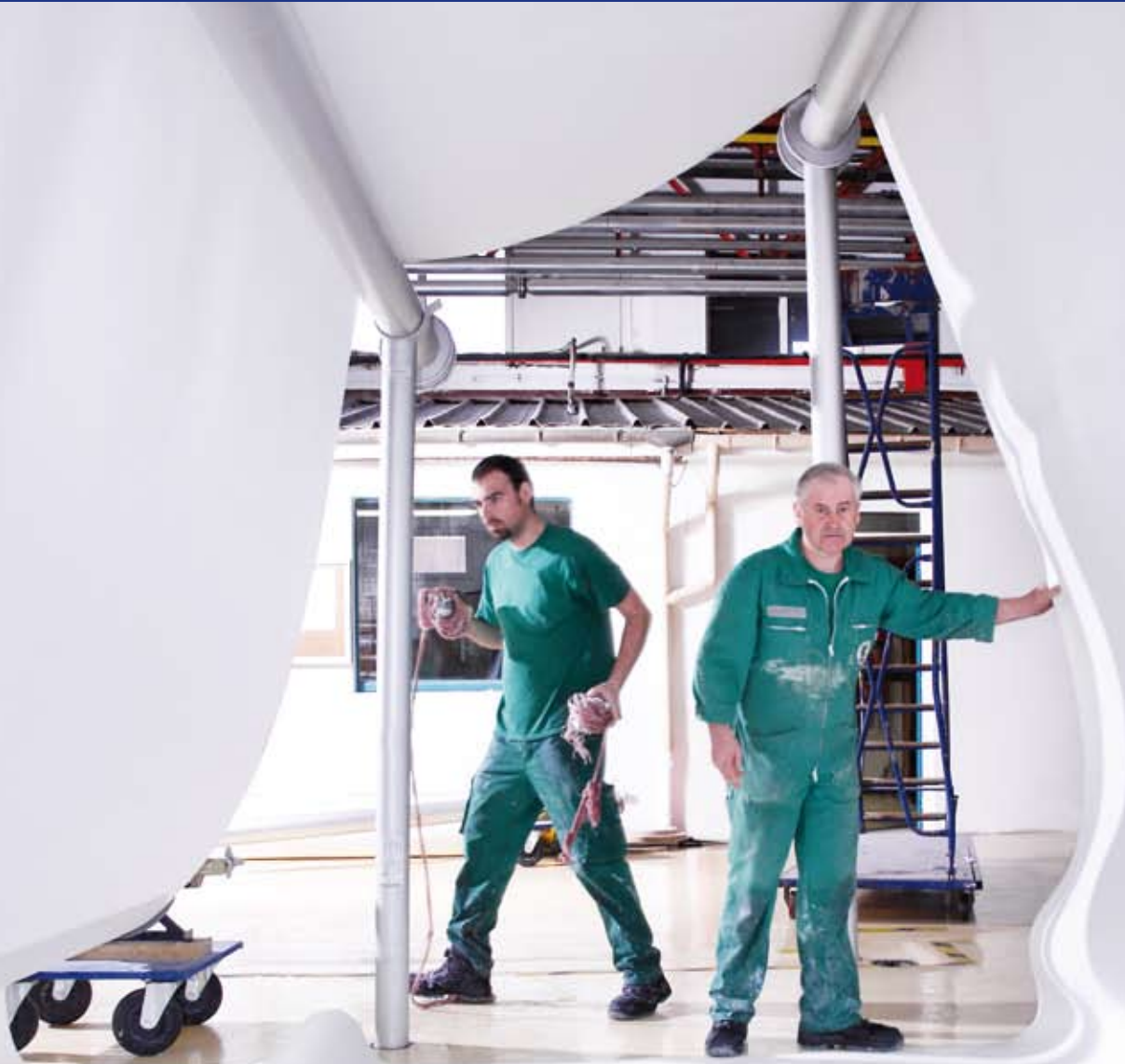
Filzwechsel in Docelles: Der Unterfilz wird für den Einbau in die Pressenpartie vorbereitet.
