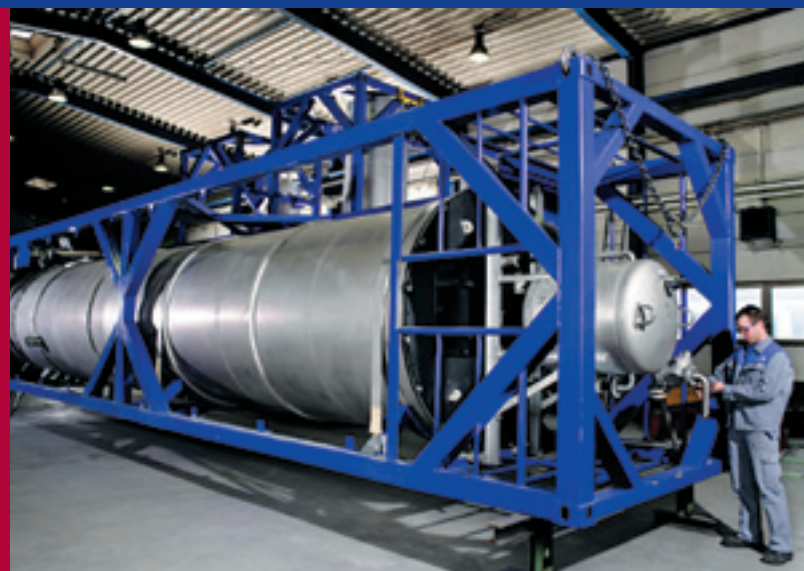
Tuotantomittakaavainen R2S anaerobinen EGSB-koereaktori valmiina ensimmäiseen asennukseen
