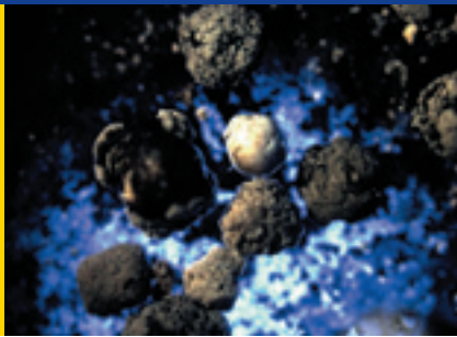
Kalkablagerungen auf den Pellets
