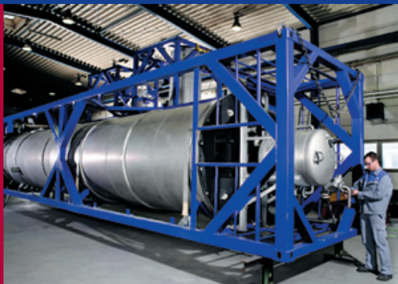
R2S anaerober EGSR-Pilotreaktor im Industriemaßstab bereit zur ersten Installation
