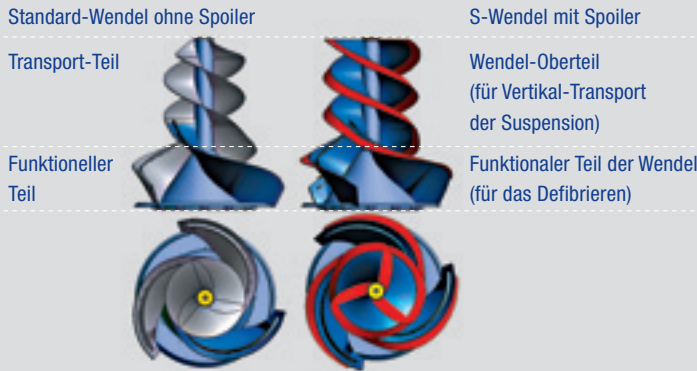
Die Modifikation einer bestehenden Standard-Wendel zu S-Wendel verringert die Auflösezeit und verbessert das Auflöseergebnis
